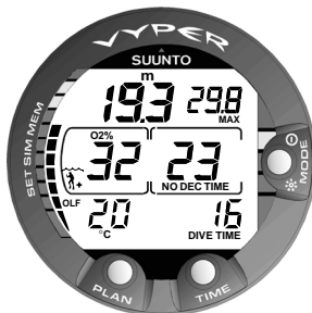
Fig. 3.22. En plongée au nitrox. Réglage O 2 % sur 32%.
