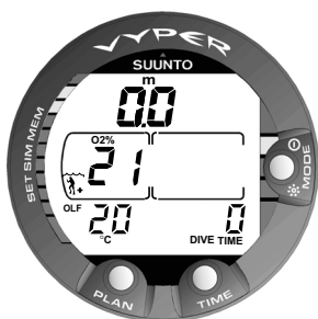
Fig. 3.21. Affichage surface en utilisation ordinateur NITROX.
