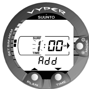
Fig. 4.20. Simulation d'un intervalle surface. Régler l'intervalle surface avec les boutons TIME et PLAN. NOTE : l'intervalle surface n'est affiché que lors de plongées successives.
