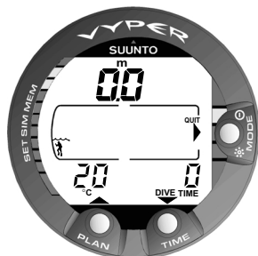
Fig. 4.18. Simulation d'une plongée. Descente en appuyant sur le bouton flèche vers le bas (TIME) et remontée en appuyant sur le bouton flèche vers le haut (PLAN).
