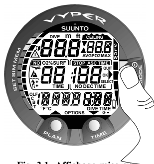
Fig. 3.1. Affichage mise en marche I. Tous les segments apparaissent.
