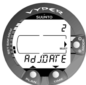
Fig. 4.36. Les réglages de la date [2 AdJ DATE].
