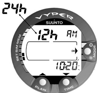
Fig. 4.35. Réglage du format et de l'heure.
