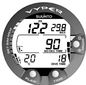
Fig. 3.11. Indicateur de vitesse de remontée. Trois segments.
