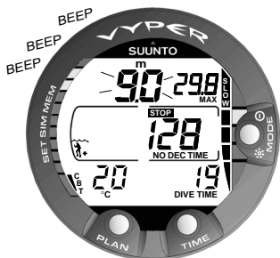
Fig. 3.13. Indicateur de vitesse de remontée. Profondeur instantanée clignotante, mention SLOW et quatre segments affichés : la vitesse de remontée est supérieure à 10 m/min. Il faut ralentir. Le signal STOP signifie qu'un palier de sécurité obligatoire doit être effectué lorsque la profondeur de 6 m est
