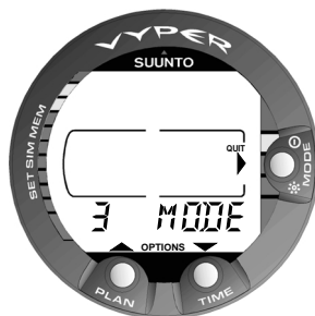
Fig. 4.1. Accès aux 3 principaux modes menu [3 MODE].
