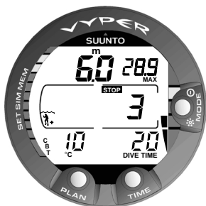
Fig. 3.10. Indicateur de vitesse de remontée. Deux segments.
