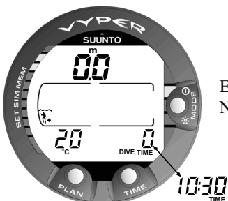
Fig 3.4. Affichage mise en marche IV. Affichage surface: la profondeur et le temps d'immersion sont à zéro (aucune plongée n'a encore été effectuée) et la température est de 20°C.
