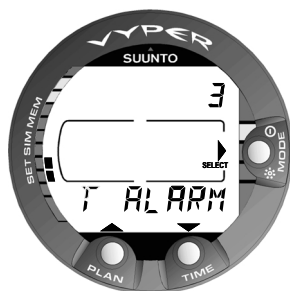
Fig. 4.38. Les réglages de l'alarme journalière [3 T ALARM].
