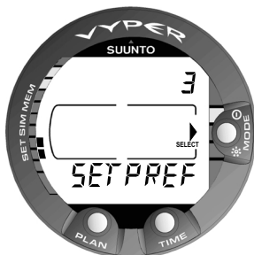
Fig. 4.40. Réglages des préférences [3 SET PREF].
