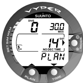
Fig. 3.6. Planning de plongée. Le planning est signalé par l'abréviation PLAN. Le temps disponible sans décompression à 30.0 m est de 14 minutes en mode A0/P1.
