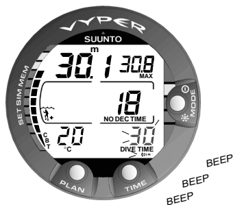
Fig. 3.32. L'alarme de temps de plongée est activée.
