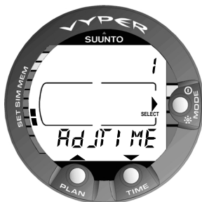
Fig. 4.34. Les réglages de l'heure [1 AdJ TIME].
