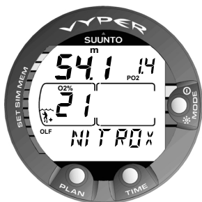
Fig. 3.20. Affichage nitrox. La profondeur maximum résultant des réglages O 2 % (21) et PO 2 (1,4 bar) est 54,1 m.
