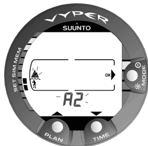
Fig. 4.25. Choix du réglage d'altitude. Utiliser les boutons de défilement pour changer de réglage.
