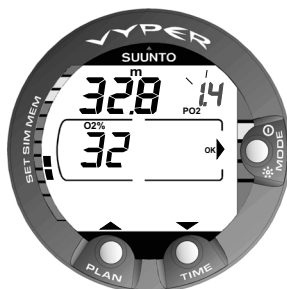
Fig. 4.32. Réglage du pourcentage et de la pression partielle d'oxygène. La profondeur maximale autorisée est 32,8 m. Utiliser les boutons de défilement pour régler le pourcentage et la pression partielle d'oxygène.
